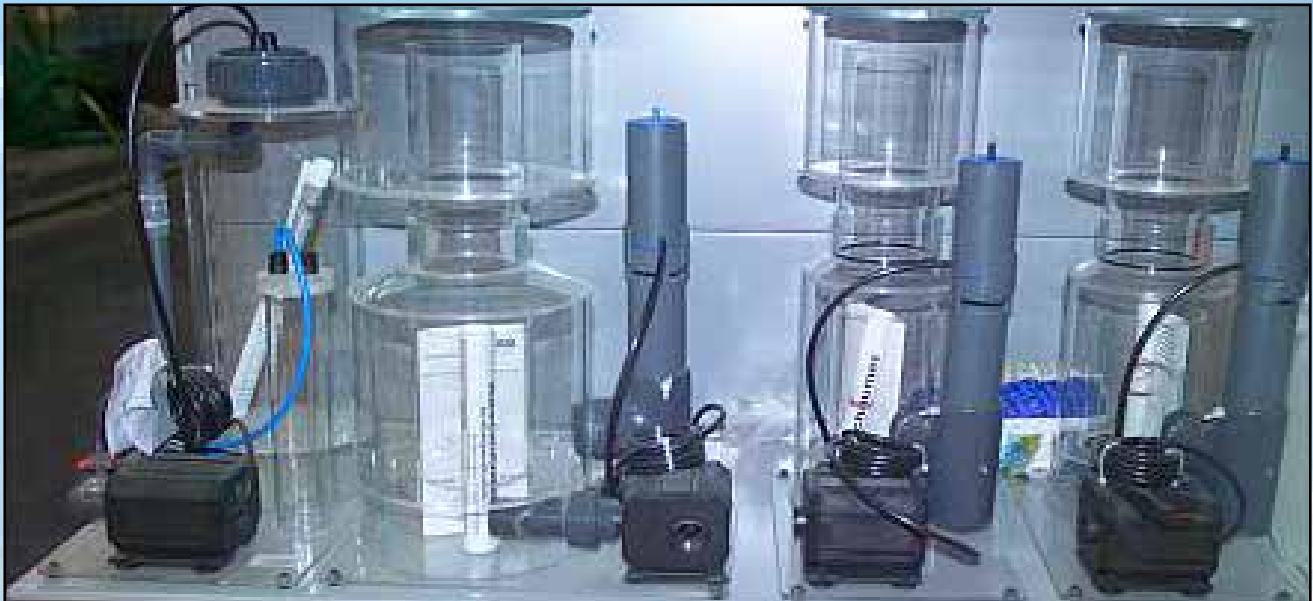
Een aantal venturi afschuimer. Die grijze lucht potten met dat slangetje eraan zijn geluidsdempers om het aanzuiggeruis van de lucht te dempen. Stil zijn ze dus niet maar wel compact!
