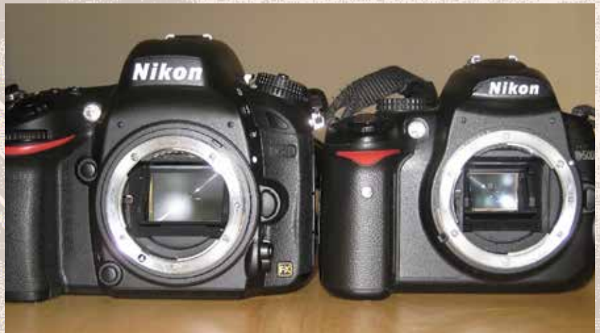
Mijn gereedschap: een Nikon D610 met full frame sensor (links) en een Nikon D5000 met de kleinere sensor (rechts). Het verschil in sensorafmeting is evenredig aan de verschillende afmetingen van de op deze foto zichtbare spiegels.
