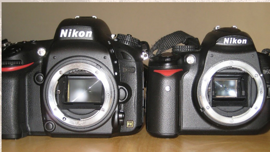
Mijn gereedschap: een Nikon D610 met full frame sensor (links) en een Nikon D5000 met de kleinere sensor (rechts). Het verschil in sensorafmeting is evenredig aan de verschillende afmetingen van de op deze foto zichtbare spiegels.
