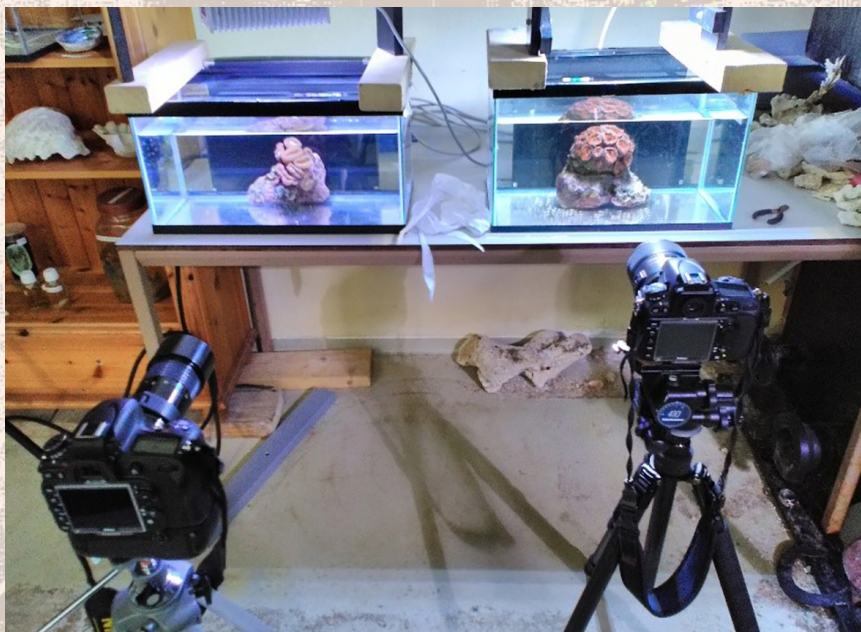
Het fotograferen van koralen in aparte aquaria heeft het voordeel van een storingsvrije omgeving. Let op de langere afstand tussen de linker camera en het aquarium door de langere brandpuntsafstand van de lens (200 mm). De camera aan de rechterkant was uitgerust met een 105 mm macro lens.
