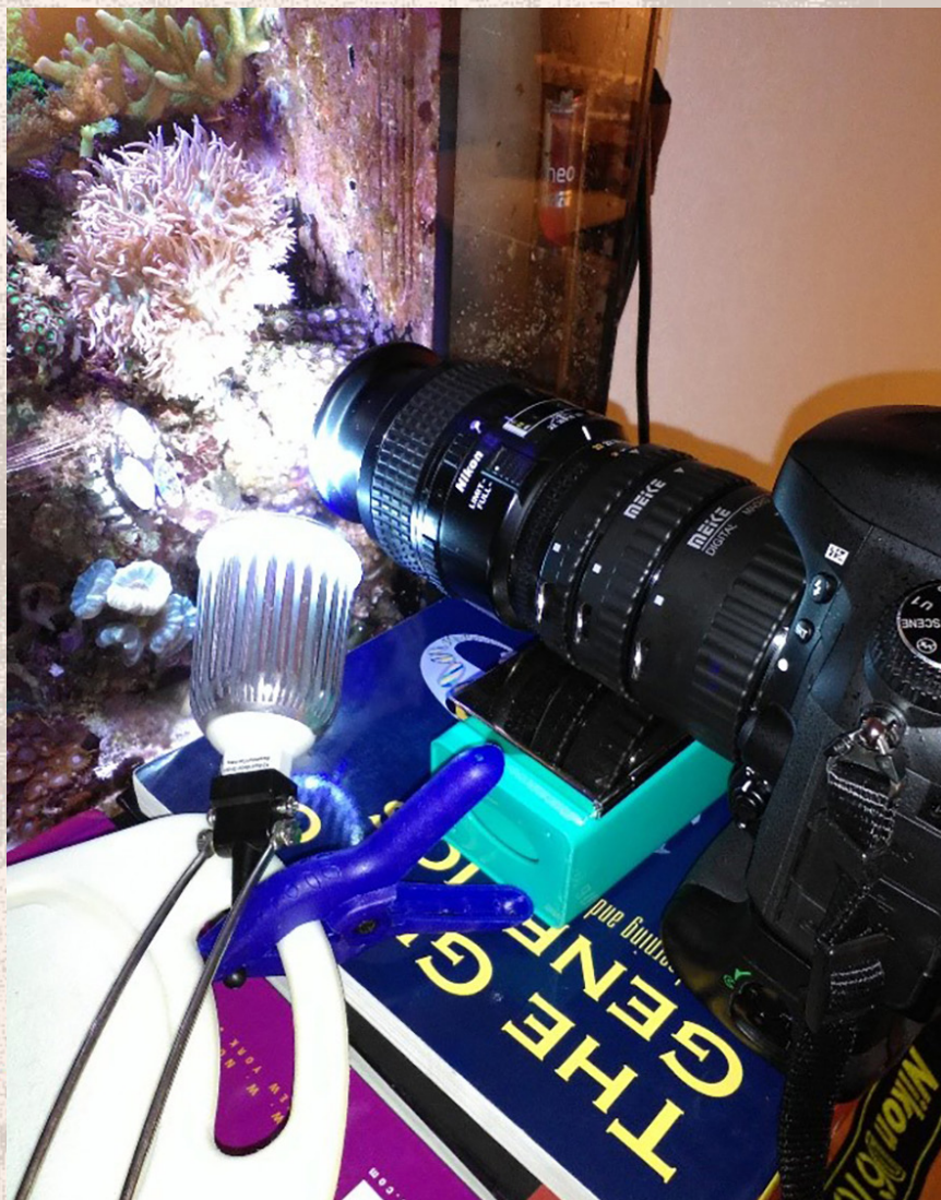
Mijn D610 met 60 mm Nikkor en Meike extension tube, bestaande uit drie aparte ringen. De Led-spot levert het noodzakelijke extra licht omdat de lange extension tube het voor de camerasensor moeilijker maakt om het licht nog op te kunnen vangen.
