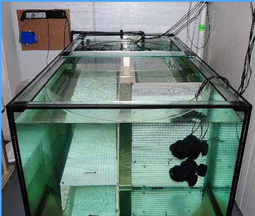
Het laminaire waterstromingssysteem dat voor de experimenten werd gebruikt. Twee acrylplaten werden aan beide uiteinden van het aquarium geplaatst, waardoor afgeronde hoeken ontstaan die turbulente waterstroom voorkomen.
