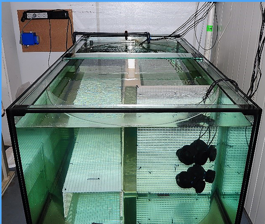
Het laminaire waterstromingssysteem dat voor de experimenten werd gebruikt. Twee acrylplaten werden aan beide uiteinden van het aquarium geplaatst, waardoor afgeronde hoeken ontstaan die turbulente waterstroming voorkomen.
