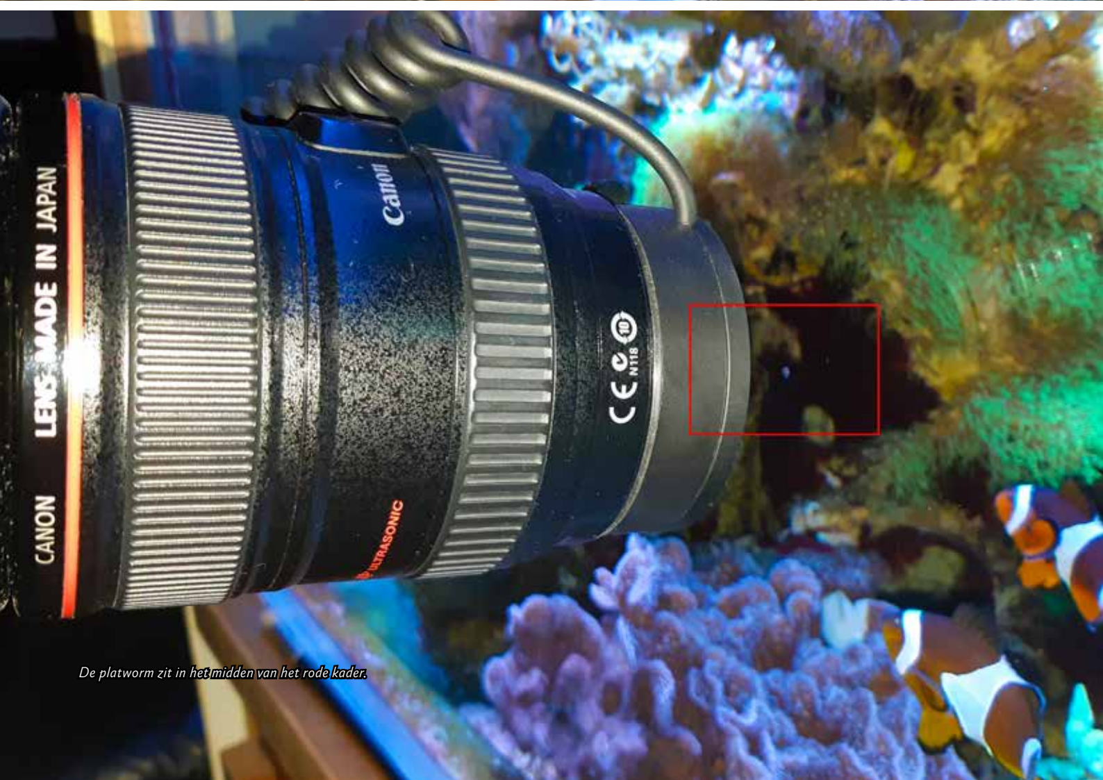
Het "EF24-105mm USM L" zoom-objectief omgekeerd gemonteerd op de camera.
