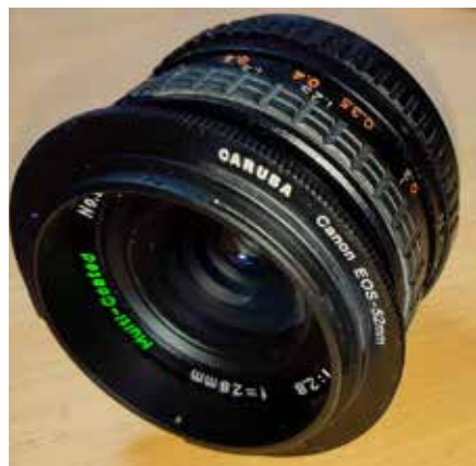
Goedkoop 28mm groothoeklens met passende omkeeradapter.
