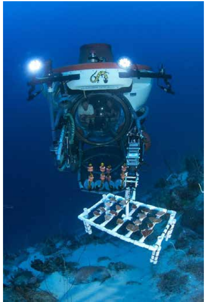
Onderzoek naar mesofotische riffen is technisch uitdagend, omdat het onderzeeërs, op afstand bediende voertuigen (ROV's) en speciale duikuitrusting vereist. Hier verplanten Dr. Pim Bongaerts en zijn collega's diepwaterkorallen voor een wetenschappelijk experiment.
