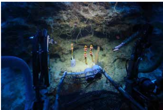
Door digitale loggers in diepe wateren te plaatsen met behulp van duikboten, kunnen wetenschappers fluctuaties in temperatuur, lichtintensiteit en andere abiotische factoren op mesofotische riffen registreren. Let op de zweepkoralen op de achtergrond. Locatie: Curaçao.
