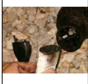
Het resultaat van corrosie/ slecht contact. Je moet er toch niet aan denken!
